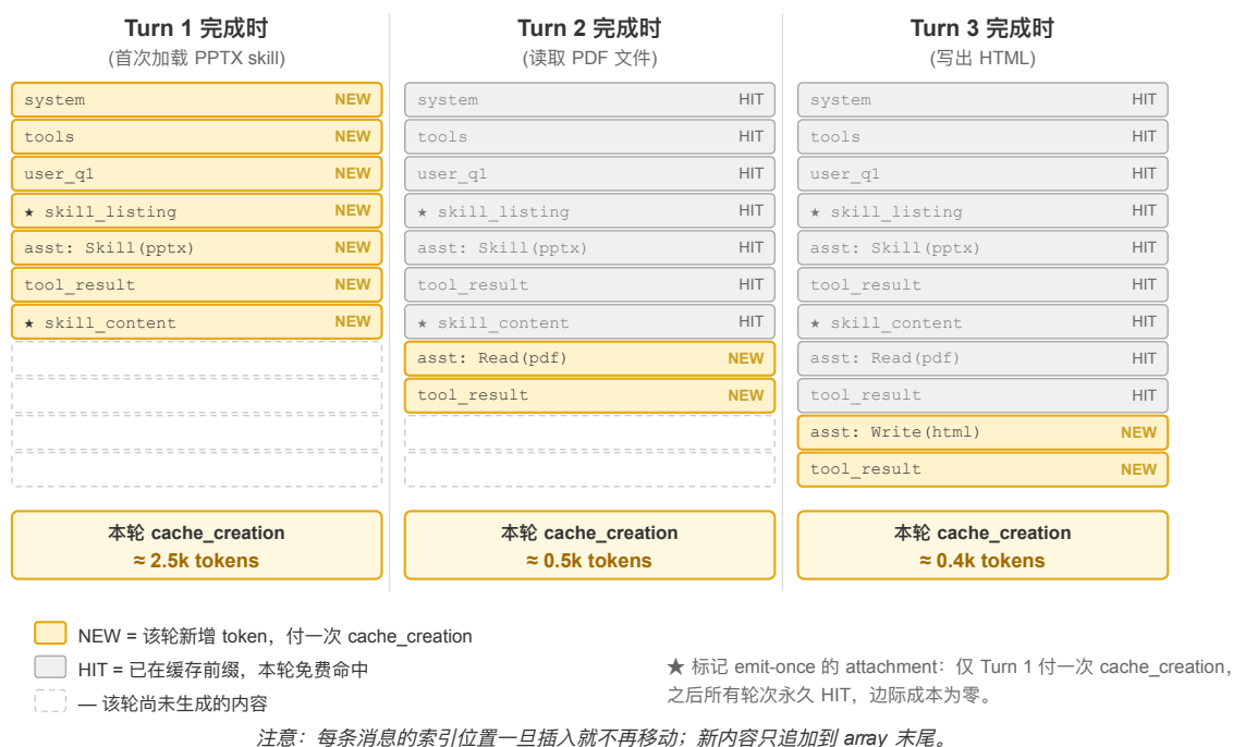
图 2-13 KV Cache 随 Agent Trajectory 增长的演化
