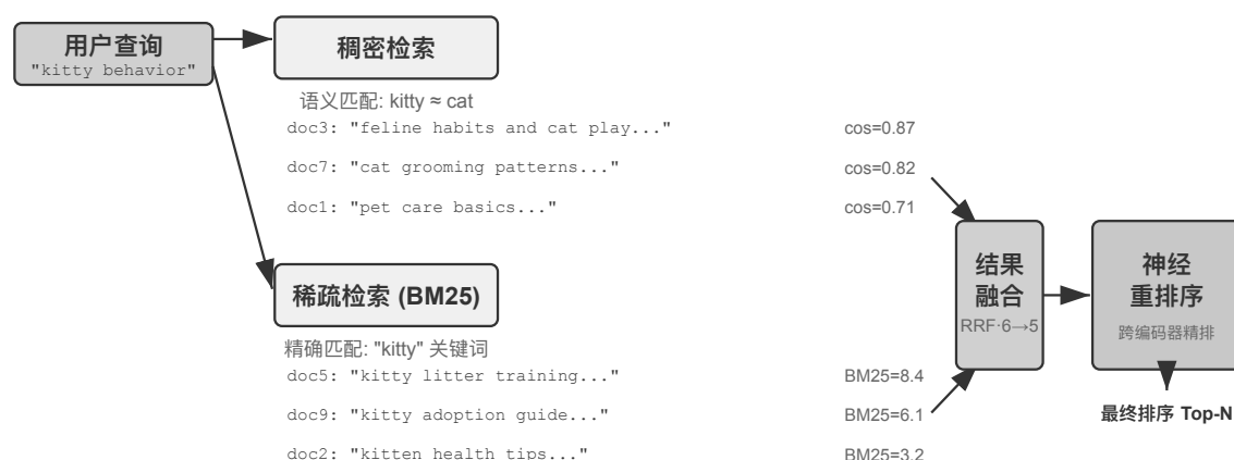
图 3-9 混合检索与重排序流水线
